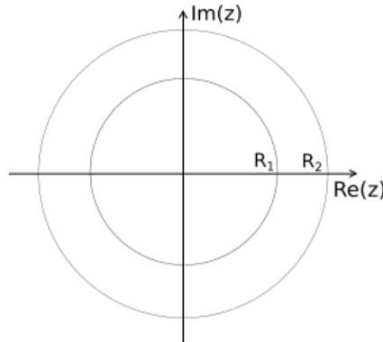
Fig1: Zylinderkondensator in der Komplexen Ebene. Die Radien der Kondensatoren sind  $R_1$  und  $R_2$
